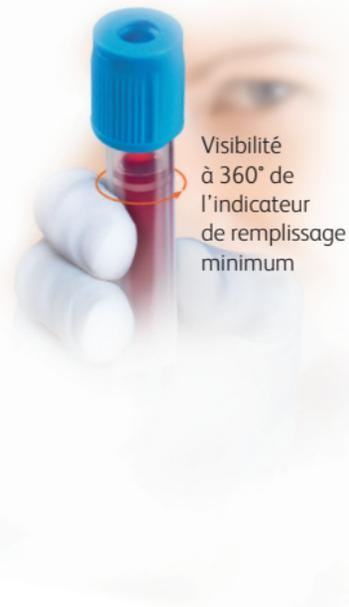
Visibilité à 360° de l'indicateur de remplissage minimum
